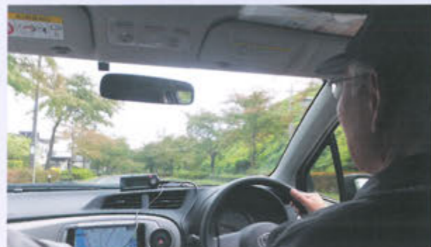
参加者は燃費計(写真ダッシュボード上)を取り付けた車両を運転し実践的に学んだ
